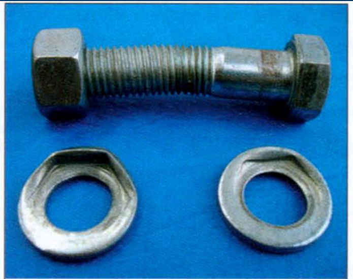
Rys. 6. Widok plastycznej deformacji podkładek rozciąganej śruby
