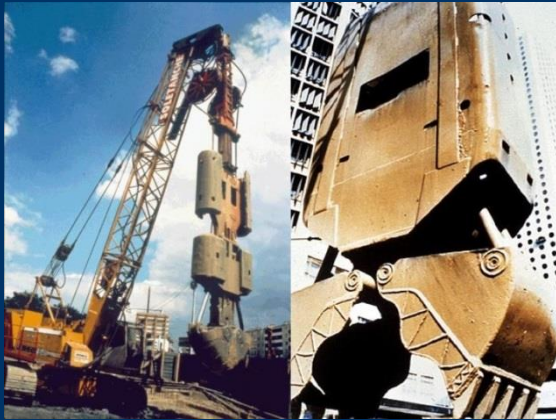
Chwytnik hydrauliczny do wykonywania ścian szczelinowych (fot. Soletanche Polska)
