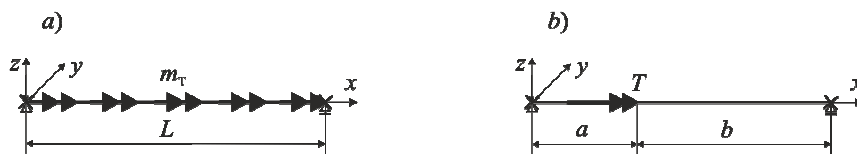
Rys. 2. a) obciążenie rozłożonym momentem skręcającym b) obciążenie skupionym momentem skręcającym
