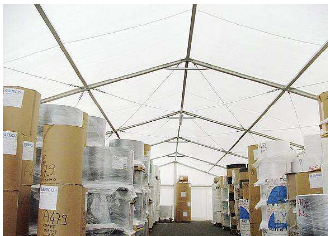
Rys.132. Przekrycie membranowe hali magazynowej [1]
