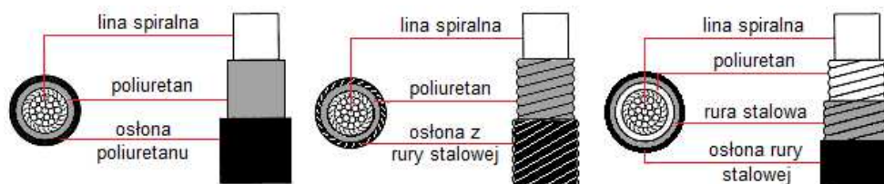
Rys.125. Przykłady zabezpieczenia antykorozyjnego liny [95]
